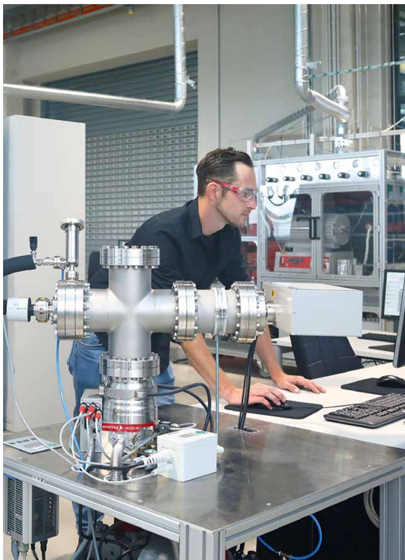
Läuft: Christian Froese, Forscher des Max-Planck-Instituts für chemische Energiekonversion, kontrolliert im Oberhausener Carbon2Chem-Labor eine Methanolsynthese. Die Vakuumröhren im Vordergrund sind Teil eines Massenspektrometers.
