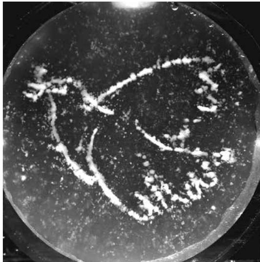
Oben: In einem Wassertank platzieren Forschende einen Ultraschallsender und ein Hologramm. Damit produzieren sie in einem Container darüber das Schallprofil, das Partikel zum gewünschten Bild zusammenreibt.
